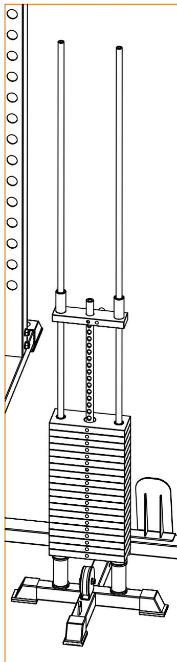
4. Inserire infine il supporto con i perni di carico [10] rendendolo solidale alla piastra con l'asta per la selezione del carico [9] mediante bulloneria (x2 vite con cava esagonale M10\*20, x2 rondella Ø11\*Ø20) inserite negli appositi fori ricavati sul supporto.
