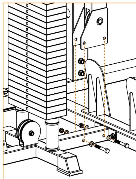
7. Assemblare al supporto per le imbottiture [3] le imbottiture per le gambe [5] utilizzando l'apposita viteria (x1 vite testa esagonale M12\*70, x1 dado M12, x2 rondella Ø13.5\*Ø24). Inserire il perno di bloccaggio [7] in una delle 4 coppie di fori per la regolazione dell'imbottitura.
