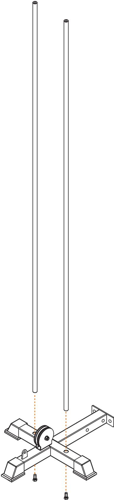
2. Disporre sul retro del profilato posteriore del power rack il telaio di base [2] con la guide [11] appena inserite, sul fronte il poggiapiedi [1]. Allineare i componenti in corrispondenza della coppia di fori ricavati su ciascun pezzo.
